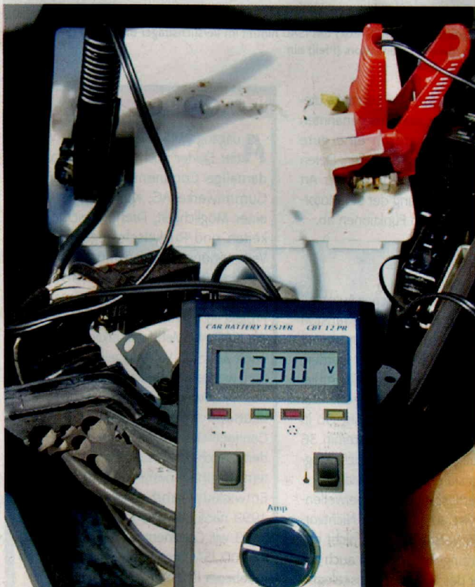
Der Kapazitätzuwachs lässt sich über einen ebensolchen Kälteprüfstrom nachweisen.
