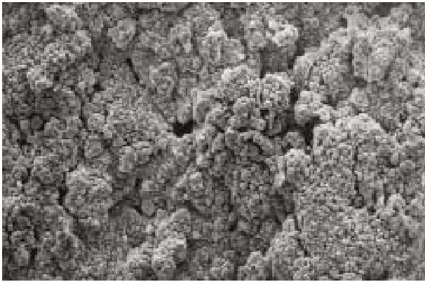
Surface des plaques d'une batterie neuve vue sous le microscope électronique. Pas de cristaux mais uniquement du sulfate de plomb amorphe.
