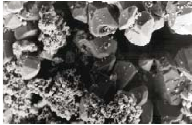
Batterie âgée de six mois sans pulseur vue sous le microscope électronique. Quelques cristaux d'une certaine taille sont déjà visibles.
