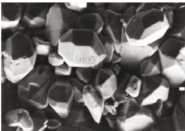
Surface de plaque après deux ans sans impulsion : elle est recouverte en grande partie par des cristaux de sulfate, d'où forte perte de capacité.
