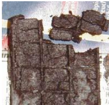
Corrosion des grilles
