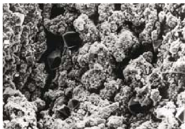
Surface des plaques au bout de onze mois avec impulsions. La batterie peut encore être rechargée entièrement.
