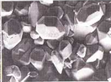
So sieht eine neue Batterieplatte unter dem Mikroskop aus (links) ... und so mit einer weit fortgeschrittenen Sulfatierung (rechts)
